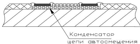
Рис.1в. Гибридно-монолитный усилитель мощности с пассивным кристаллом и однополярным питанием (с автосмещением).
