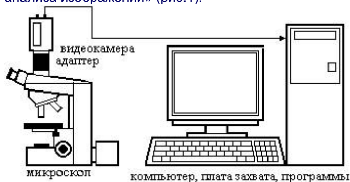
Рис.1. Схема цифрового микроскопа.
