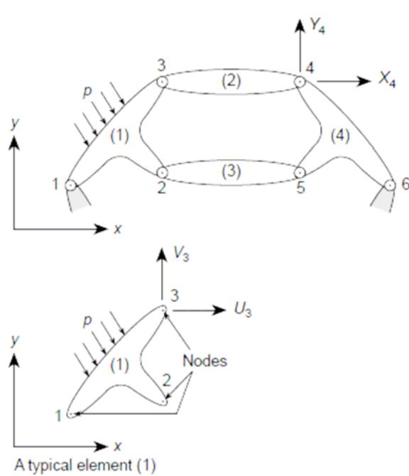
Рисунок 1.1 – Типичная конструкция, составленная из отдельных элементов
