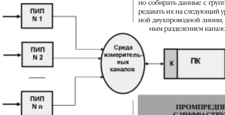
Рис. 4б. Вариант обобщенной структурной схемы АСКУЭ: двухуровневая схема с контроллерными функциями сбора, встроенными в ПК
