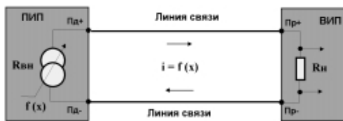
а) схема подключения датчика с токовым выходом
