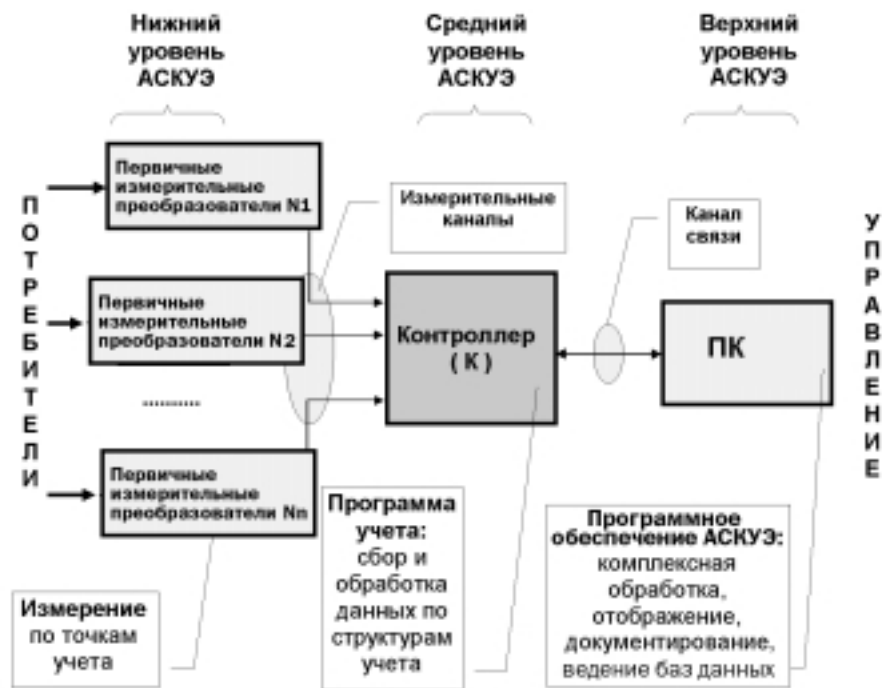
Рис. 3. Обобщенная структурная схема трехуровневой АСКУЭ
