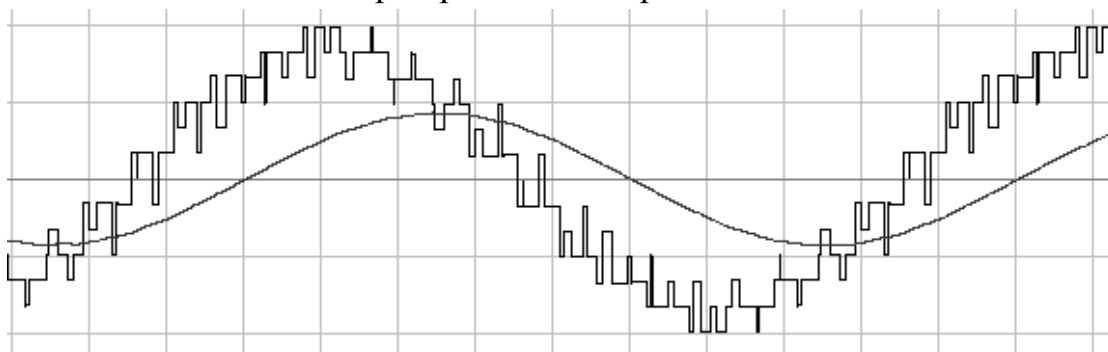
Рисунок 4 – Осциллограммы выходного напряжения и тока фазы МАИН
