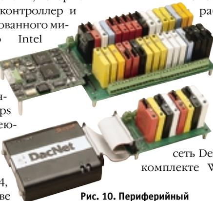
Рис. 10. Периферийный CAN-контроллер DacNet фирмы Grayhill
