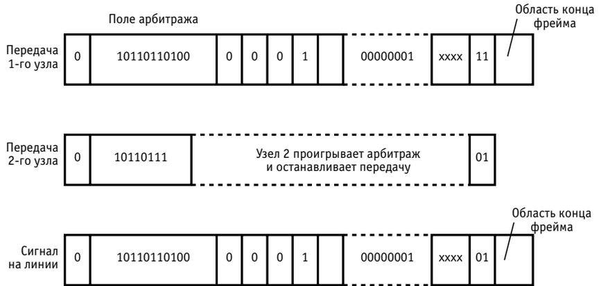
Рис. 6. Пример поразрядного арбитража
