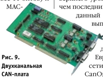
Рис. 9. Двухканальная CAN-плата PCL-841 фирмы Advantech
