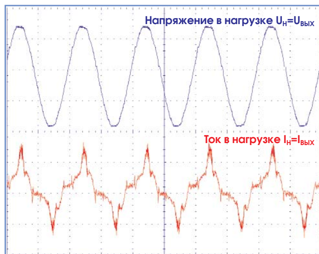
Рис. 6. Форма напряжения и тока на выходе параллельной системы
