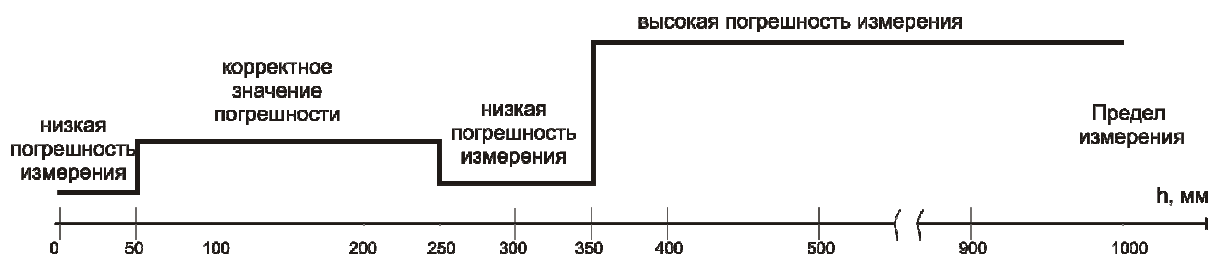
Рисунок 2 – Поле зрения портативного пирометра QT-3
