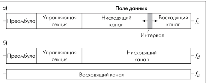
Рис.3. Структура кадра в стандарте IEEE 802.16 для систем с временным (а) и частотным (б) дуплексированием каналов
