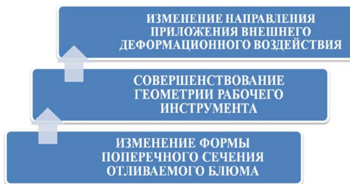
Рисунок 1. Направления усовершенствования классической схемы “мягкого” обжатия блюмов
