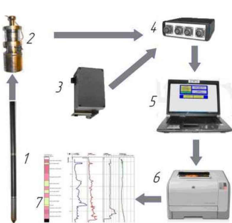
Рис. 1. Беспроводная система СРТ компании «Geotech»: 1 – зонд СРТ; 2 – микрофон; 3 – синхронизатор глубины; 4 – интерфейс ПК; 5 – ПК; 6 – принтер; 7 – результаты.
