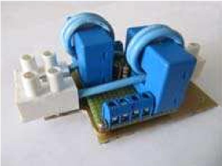
Рисунок 1 – Плата датчиков тока.
