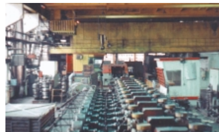
Цех гнутого профиля МК «Запорожсталь». Профилегибочный агрегат ПГА 2-7*80-500
