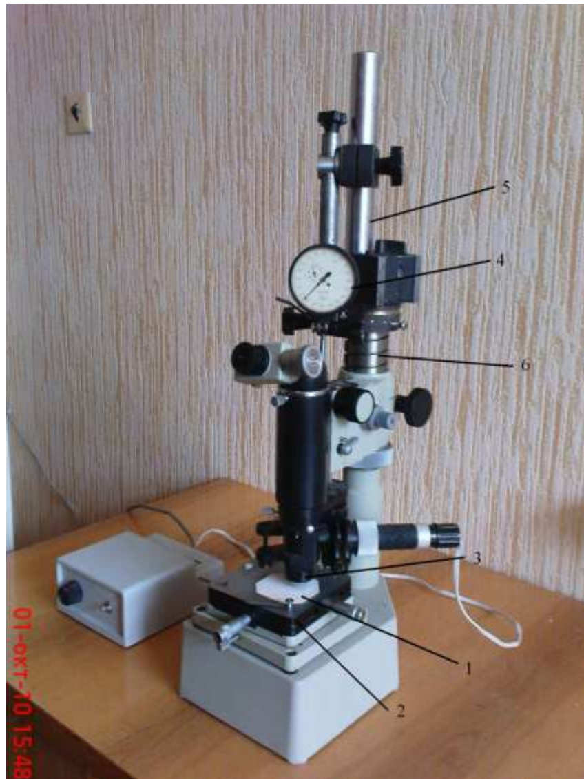
Рисунок 1 – Мікротвердомір ПМТ-3, оснащений для вимірювання розмірів зерен залізо-абразивного порошку
