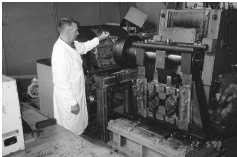
Рисунок 3. Общий вид ПОМ для деформации металла с дополнительными макросдвигами в поперечном сечении заготовки.
