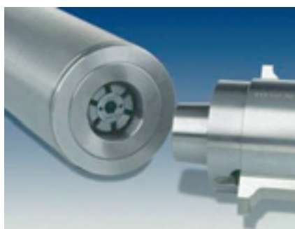
Полый конусный хвостовик зажимной системы HSK (Leitz-PowerLock)
