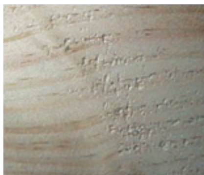
Поверхность заготовки. Окончательная (чистовая) обработка без предварительной обработки.
