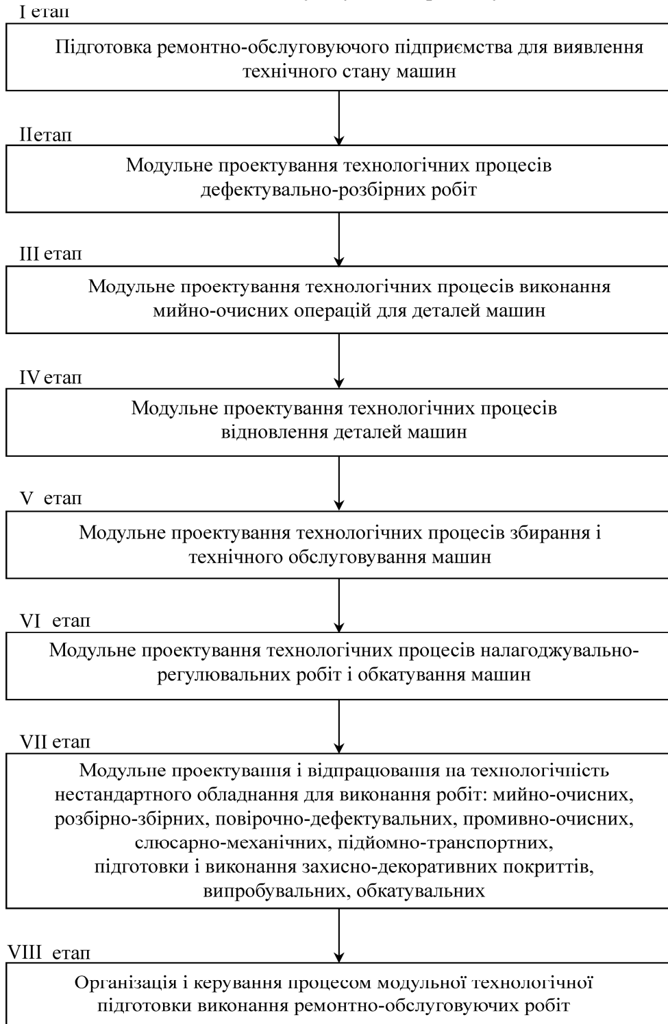
Рис.2. Схема системи модульної підготовки технічного обслуговування й ремонту машин
