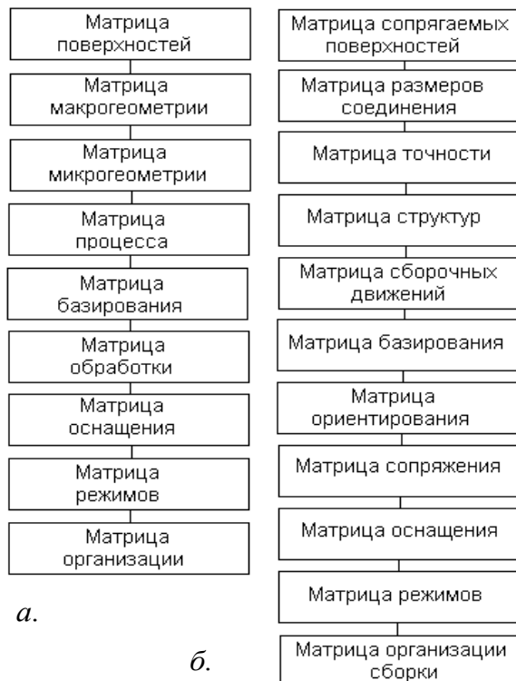
Рис.4. Иерархические уровни структурирования модульной сборочной технологии: а – собираемой детали; б – сборочного узла
