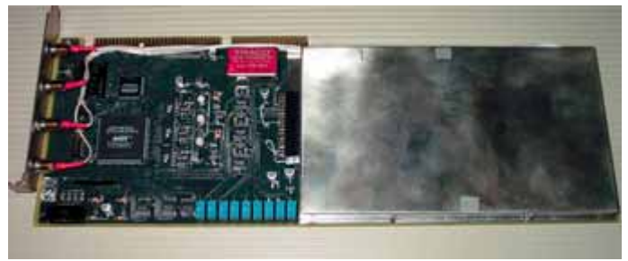
Рис. 6. Внешний вид платы первичного контроля (приёмопередатчики в правой части платы закрыты защитным экраном)
