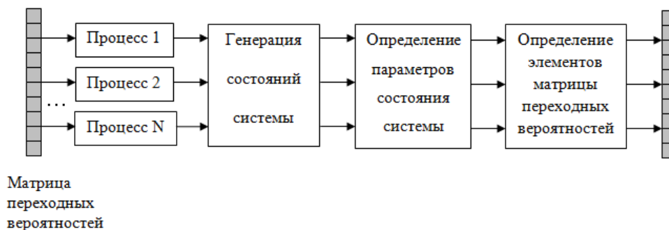
Рис. 5. Параллельный алгоритм построения матрицы переходных вероятностей
