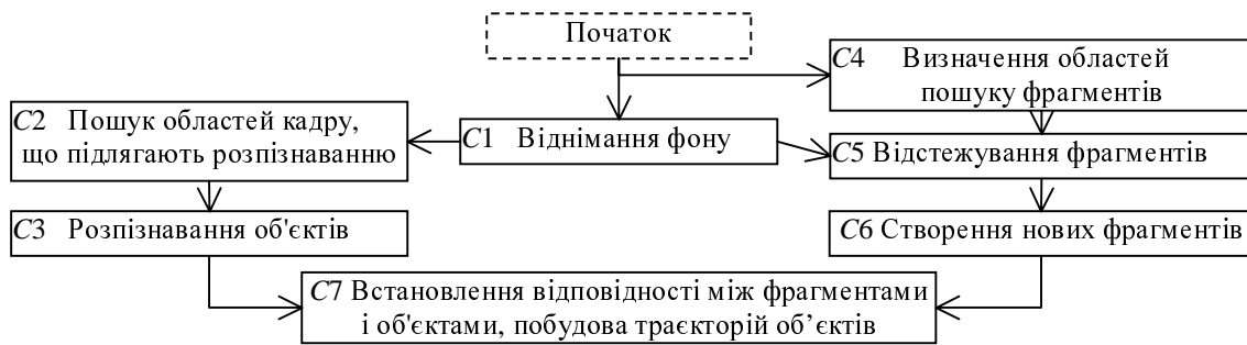
Рисунок 5 – Граф інформаційних залежностей алгоритму відстежування
