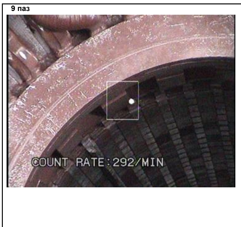
Рис. 5. Коронная активность различных фрагментов (в пределах выделенной квадратом области) уложенных в пазы стержней при испытаниях обмотки статора ТВВ-800 после ремонта. Испытания от постороннего источника при 31кВ ( разрядная активность в области выхода 9-стержня из паза.
