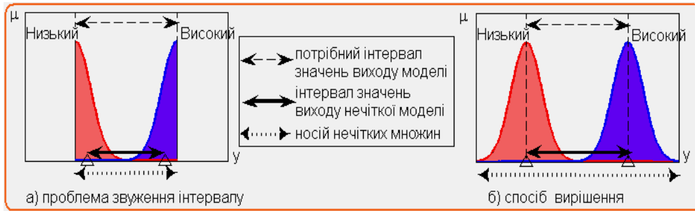
Рис. 2. Звуження інтервалу внаслідок дефазифікації за центром тяжіння
