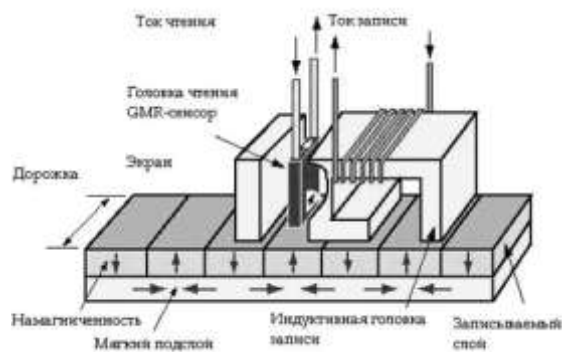
Рис.1. Схема технологии перпендикулярной записи
