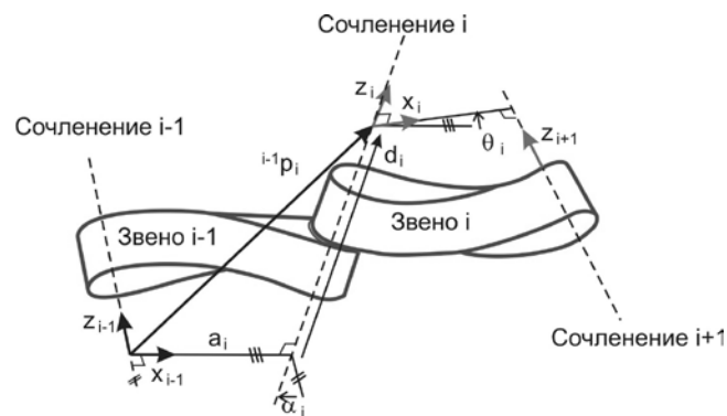
Рисунок 2 – Система координат звена и ее параметры при использовании модернизированного преобразования Денавита-Хартенберга [6]
