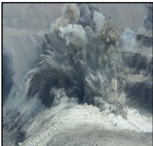
Рис. 4. Взрыв ЭВВ в карьере на РУПП Гранит
