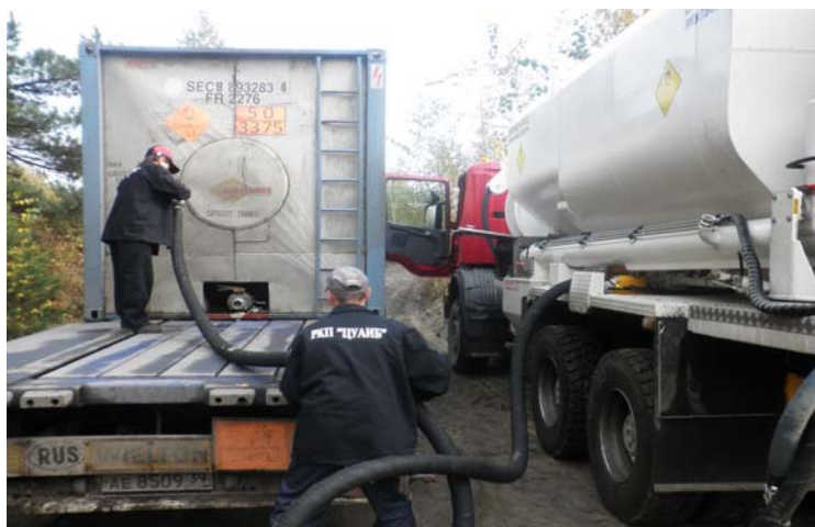
Рис. 1. Загрузка смесительно-зарядной машины «Универсал» компонентами ЭВВ
