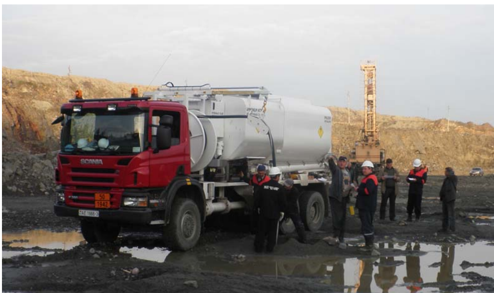
Рис. 2. Загрузка ЭВВ в скважину на РУПП Гранит
