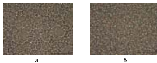
Рис. 2. Дисперсность обратной эмульсии (увеличение 720): а — аммиачная селитра, кальциевая селитра; б — аммиачная селитра, кальциевая селитра, натриевая селитра
