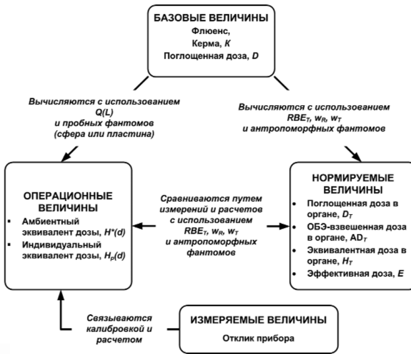
Рис.2. Связь между базовыми, нормируемыми и операционными дозиметрическими величинами.
