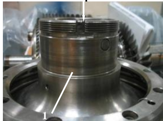
Рисунок 2 – Барабан ротора компрессора вертолетного двигателя: 1 – изнашивающаяся шейка цапфы барабана компрессора
