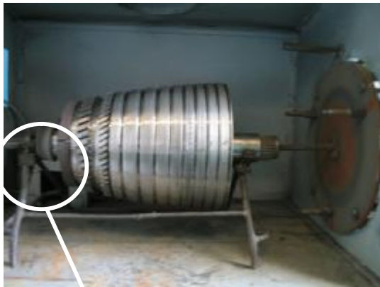
Рисунок 3 – Подготовленная под напыление расточенная поверхность кольца
