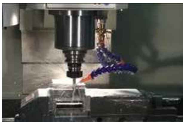
Рис. 11. Обработка заготовки на станке Optimum F100
