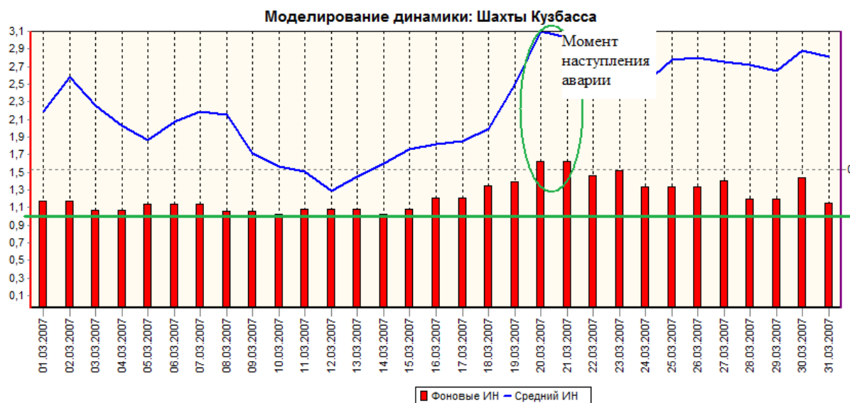
Рис. 3.3. Моделирование аварий на шахтах Кузбасса (фоновая ситуация и включенная ситуация)
