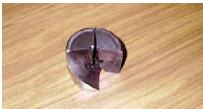
Рис. 4. Ролик подшипника МКК №6 на ручье №5 МНЛЗ №3 расколот на три части
