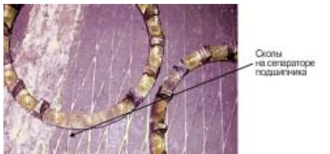
Рис. 7. Сколы на сепараторе подшипника
