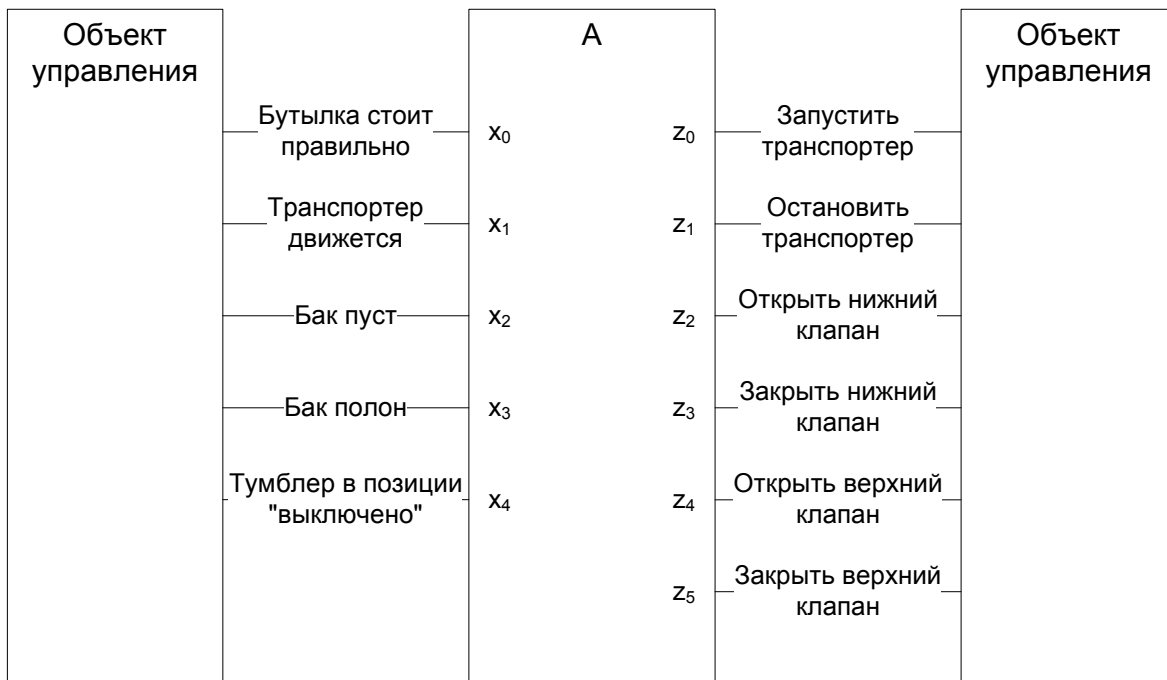
Рис. 12. Схема связей управляющего автомата разливочной линии
