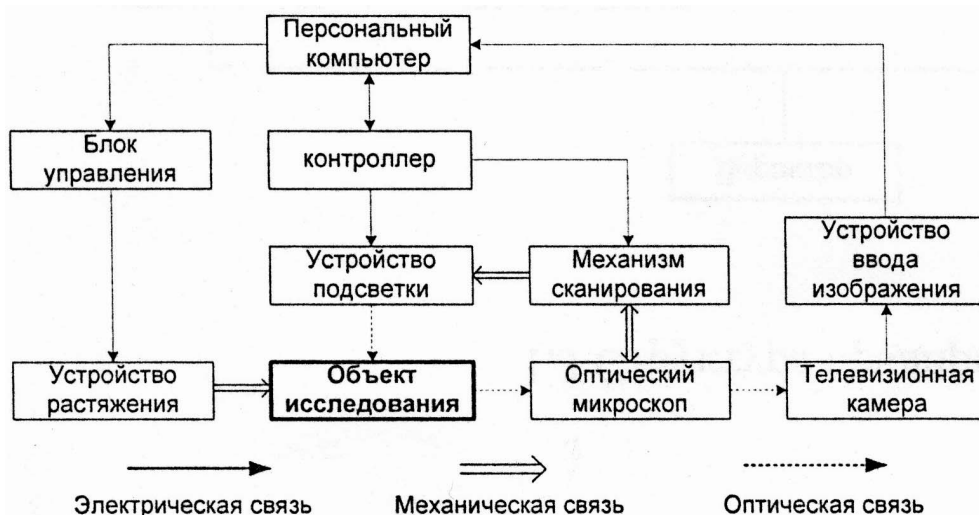
Рис. 2. Обобщенная структурная схема ОТИС
