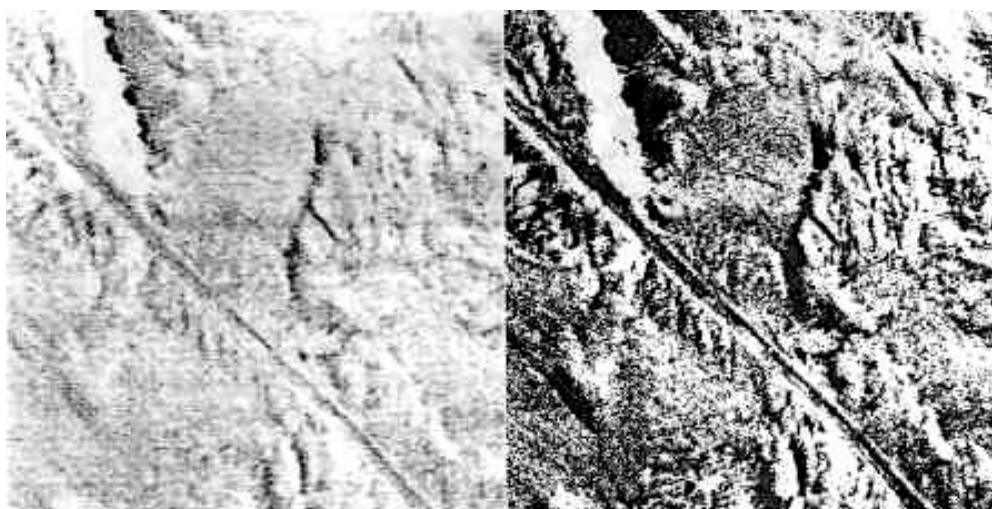
Рис. 5. Результат бинаризации с локальным порогом исходного и сглаженного изображений стали
