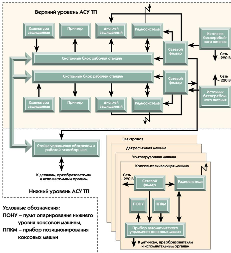
Рис. 1. Структурная схема АСУ ТП коксовой батареи
