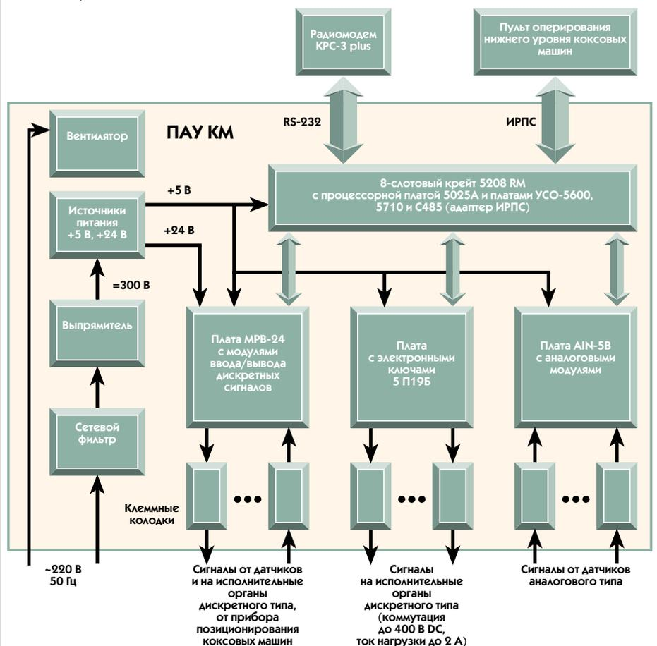
Рис. 7. Структурная схема прибора автоматического управления коксовой машиной
