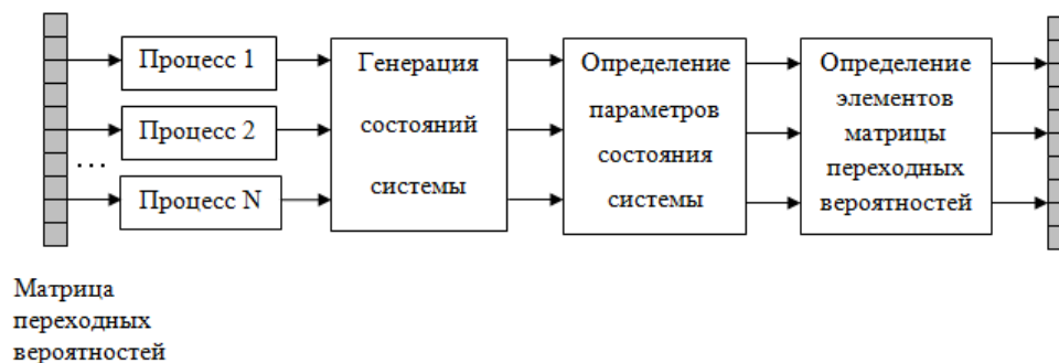
Рис. 5. Параллельный алгоритм построения матрицы переходных вероятностей
