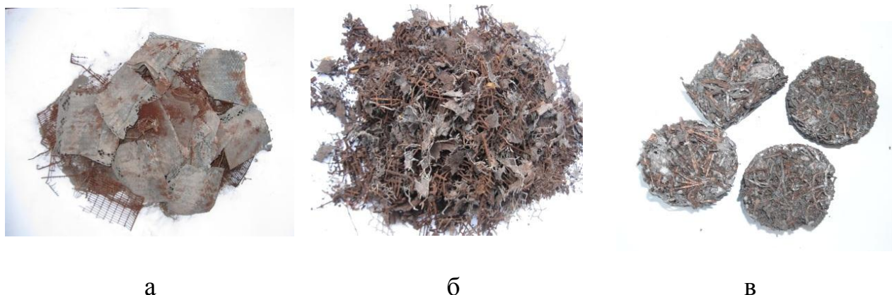
Рисунок 1.- Брикетирование свинецсодержащего сырья а – исходный аккумуляторный лом; б – измельченная шихта; в - готовый брикет
