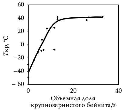
Рис. 5. Влияние объемной доли крупнозернистого бейнита на температуру вязко-хрупкого перехода ( T_{кр} )
