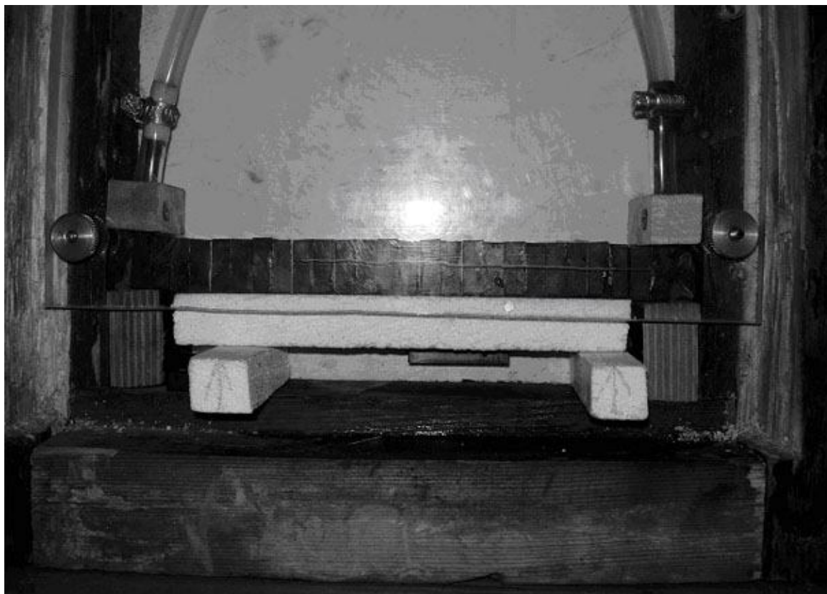
Рис. 3. Общий вид модели до потери устойчивости (размер блока 0,14 l/B , 1 слой).
