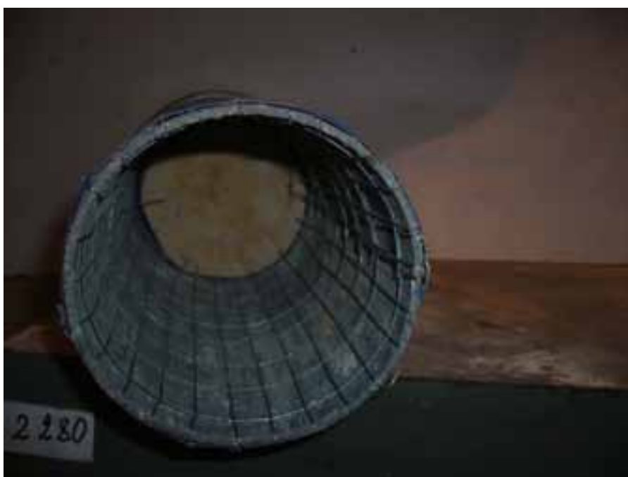
Рис. 3. Общий вид оболочки армированной металлической сеткой при подготовке модели
