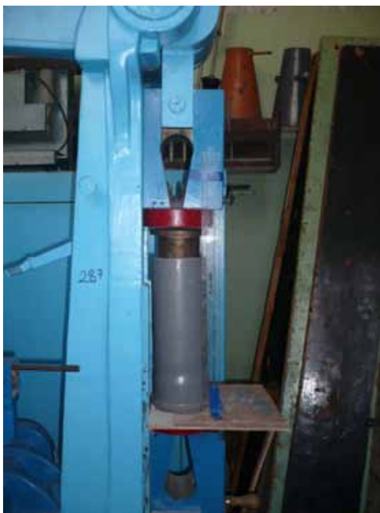
Рис. 3. Общий вид оболочки армированной металлической сеткой при подготовке модели
