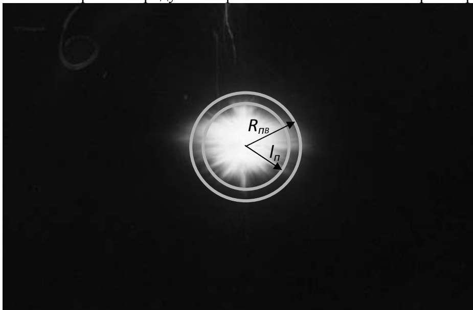
Рис. 2. Разлет газообразных продуктов взрыва угленита Э-6 и траектория частиц
