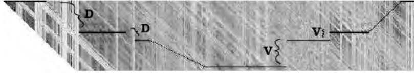
Рис. 4: DSI_i . Горизонтальная ось – x . Вертикальная ось – d . Черные пиксели соответствуют близким к 0 значениям. Скачки V и D соответствуют заслоненным областям. Горизонтальные участки означают нахождение точного соответствия. Наклонные участки соответствуют наклонным поверхностям.
