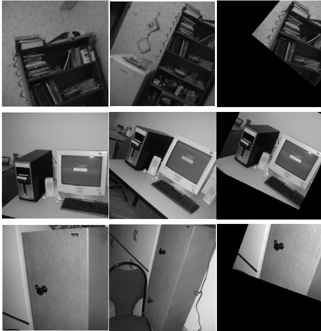
Рис. 4. Результаты работы алгоритма. Левый столбец – первое изображение, средний столбец второе изображение, правый столбец - первое изображение, преобразованное найденным проективным преобразованием
