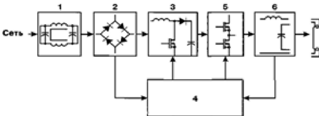
Рисунок 1 – Структурная схема электронного аппарата включения
