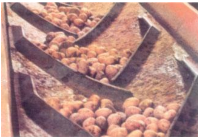
Рис. 2. Конвейерная лента с перегородками на рабочей поверхности
