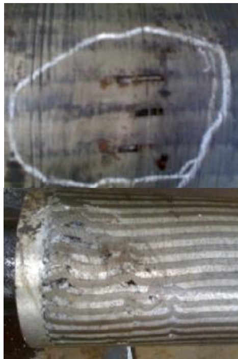
Рисунок 1 – Примеры выплавления обмотки ротора
