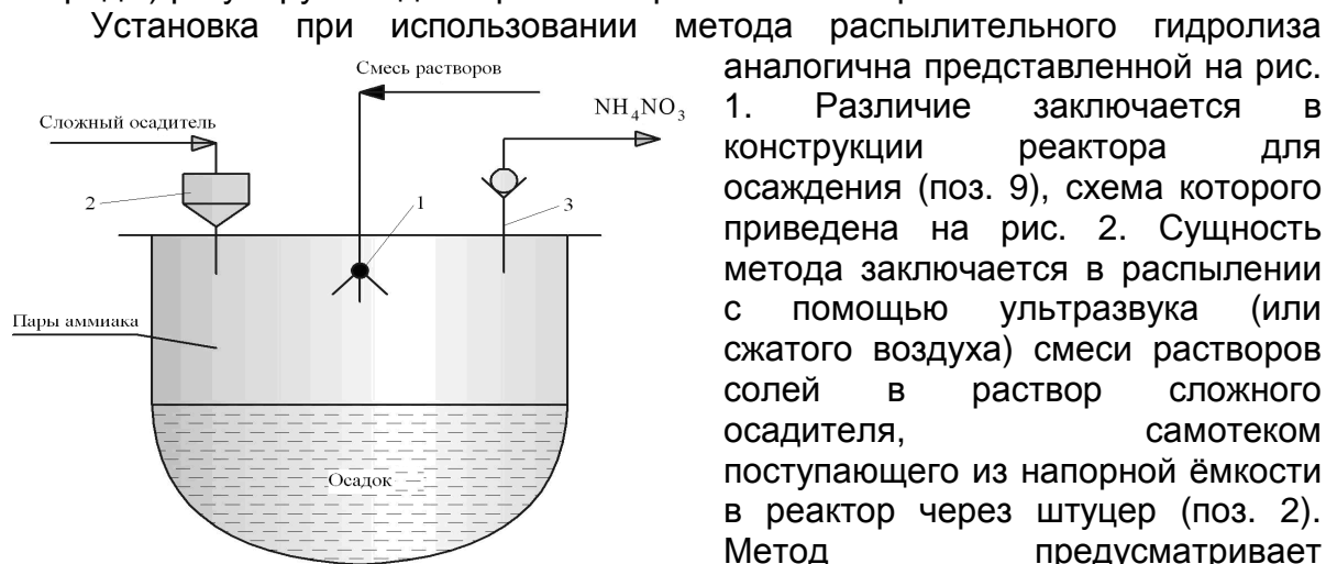
Рис. 2. Схема реактора для осаждения по методу распылительного гидролиза: 1 – ультразвуковой диспергатор; 2 – штуцер для подачи сложного осадителя; 3 – штуцер для выхода паров \text{NH}_4\text{NO}_3
