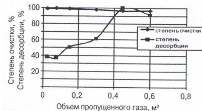
Рисунок 1 – Зависимость степени очистки газа от SO 2 и степени десорбции от объема пропущенного газа
