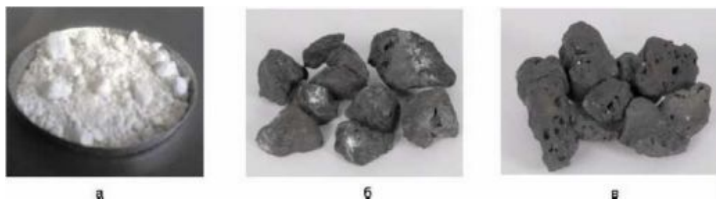
Рис. 1. Внешний вид исходной меловой крошки (а), железофлюса, получаемого совместным обжигом смеси кускового мела и железной стружки (б) и внутреннее строение его гранул (в)
