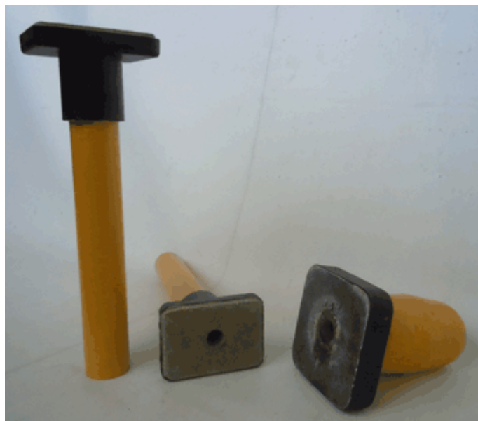
Рисунок 5 - Комплект огнеупорных элементов разработанного разливочного устройства
