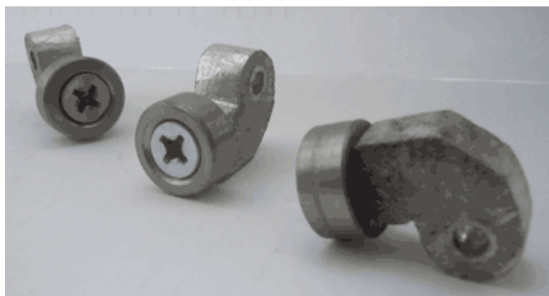
Рисунок 6 - Поворотные прижимные элементы, снабженные роликами
